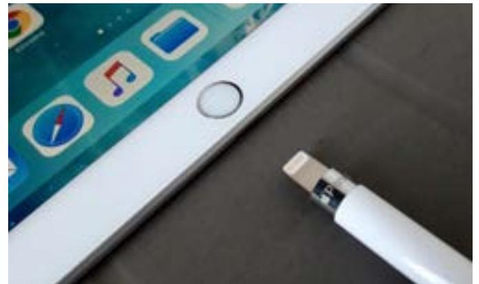
③Apple Pencilのキャップを取り外し、iPadのLightningコネクタに接続します。
